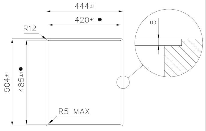
Built-in cut out for FTS - Foratura per installazione FTS
